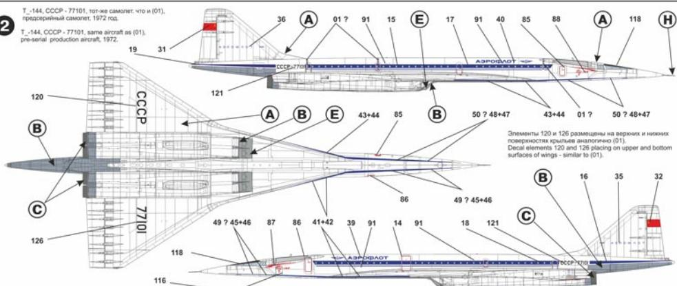
Элементы 120 и 126 размещены на верхних и нижних поверхностях крыла аналогично (01). Decal elements 120 and 126 placing on upper and bottom surfaces of wings - similar to (01).
